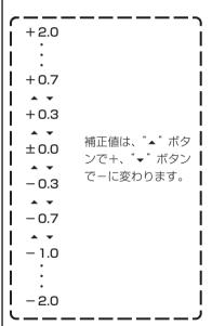
コストロボ撮影のとき、露出補正の値は、液晶モニターの表示にかかわらず、±1.0までになります。
