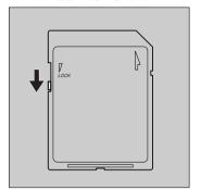
SDメモリーカードにはライトプロ テクトスイッチがついています。 このスイッチを下にスライドすると カードへのデータ書込が禁止され、 カードに保存されている画像などの データが保護されます。
