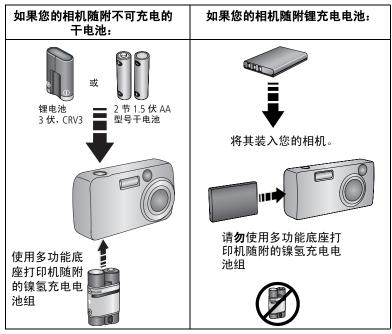
注: 在您收到镍氢充电电池组和锂充电电池时,它们均未充电。 在相机上使用它们之前,请确保已完全充电 (请参阅第 9 页)。
