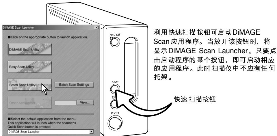
当点击“Batch Scan Utility”按钮时，扫描仪将进行初始化。当出现“装入托架”提示信息时，请将托架插入扫描仪；将扫描并保存托架中的所有画面，然后自动弹出托架。若要扫描另一批，请更换托架中的胶片，然后将胶片重新插入扫描仪。点击“Batch Scan Utility”按钮，开始扫描。扫描仪仅在扫描第一个托架时需要进行初始化。
