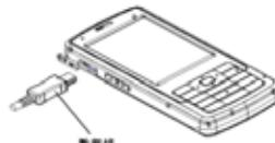
开机充电时话机屏幕电池容量图标自右向左动画显示，电池充满以后电池容量以满格静止显示。
