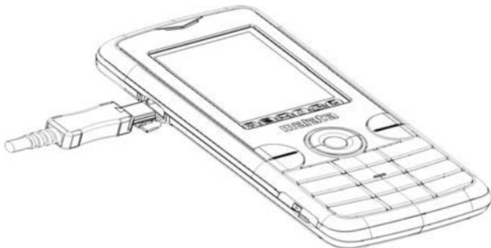
开机充电时手机屏幕电池容量图标自右向左动画显示，电池充满以后电池容量以满格静止显示。
