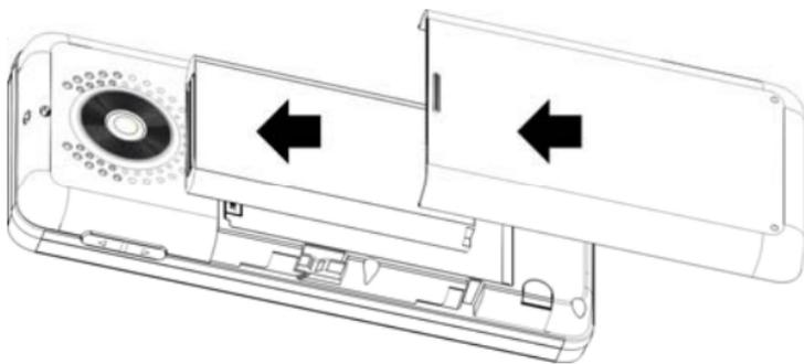
**注意：**请按照图示正确操作以防损坏电池接触点。
