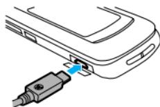
机和计算机间传输数据，将**USB**数据连接线插入手机的**USB**端口。将数据线的另一端连接到计算机上。
