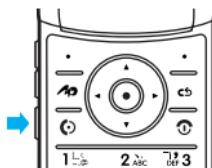
**提示：**在待机状态翻盖打开时，按智能键开启照相机。翻盖闭合时，按住智能键锁定或解锁外键。
