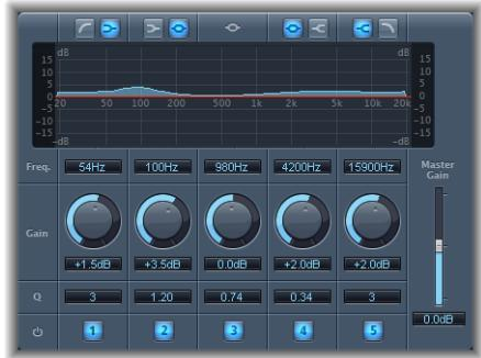
Fat EQ（加厚均衡）效果器是一个功能丰富的多频段 EQ，有多达五个单独的频段。您可以将 Fat EQ 用于单独的轨道也可以用于整体混音。Fat EQ 包括 EQ 曲线的图形显示和每个波段的一套参数。
