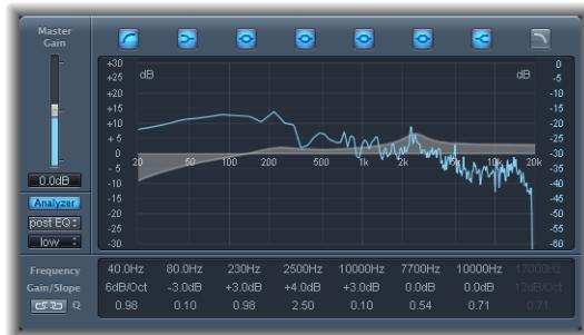
在外观上，高质量 Linear Phase EQ（线性相位均衡）效果器类似于 Channel EQ，它们有相同的参数和八波段布局。然而，Linear Phase EQ 使用的基本技术不同：即使当您将最混乱的 EQ 曲线应用于最尖锐的信号瞬变时，它也百分之百地保留音频信号相位！
