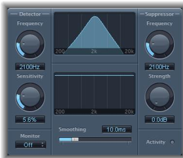
Detector 参数处于检测器窗口左侧，Suppressor 参数处于右侧。居中部分包括了 Detector 和 Suppressor 显示以及 Smoothing 滑块。
