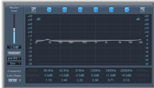
Channel EQ（声道均衡器）是一种功能非常多的多波段 EQ。它有八个频段，包括高低通滤波器、高低倾斜滤波器和四个灵活参数波段。Channel EQ 还具有集成式 FFT（快速傅里叶变换）Analyzer 的功能。您可以通过该 Analyzer 来查看要修改音频的频率曲线，从而了解需要提升或剪切哪部分频谱。
