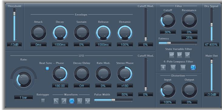
AutoFilter（自动滤波器）是一种具有多种独特功能的多用滤波器效果器。您可以使用该滤波器创作经典模拟风格的合成器效果，或者将其用作创造性声音设计的工具。使用合成器风格的 ADSR 包络和低频振荡器 (LFO) 可以对滤波器截止进行动态调制。此外，您可以选取不同的滤波器类型和斜率，控制谐振量，添加失真来产生更激昂的声音，以及将原始干信号与经过处理的信号进行混合。
