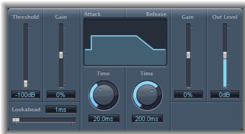
左侧的 Gain 和 Time 控制钮可应用到信号的起音部分，而右侧的 Gain 和 Time 控制钮则可应用到释音部分。
