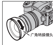
按照箭头所示方向旋转安装广角转换镜头。
