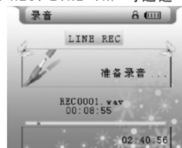
2. LINE-IN: 将LINE-IN数据线的一端与外机(电脑或CD机)相连, 另一端接在本机的LINE-IN接口上。先将本机调到录音菜单的LINE-IN模式下, 使其进入“准备录音”的状态。再打开外机上所需录制的文件, 进入播放模式后, 在本机上短按[REC]即可开始录音(如右图)。短按[REC]键暂停录音, 长按[REC]键保存录音文件并进入下一次录音准备状态, 长按[MODE]键保存录音并退出录音模式。
