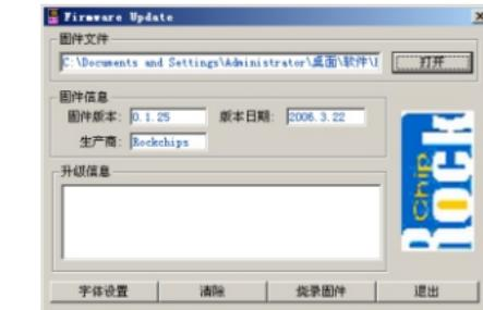
5. 通过USB缆线将播放器联机到PC机上(联机前要用手将五档按键上推并按住不放), 然后点击 [烧录固件]即可, 直到自动升级成功(如右图示)。
