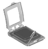
2. 寻找CPU上的两个定位 口, 使定位口与CPU插槽的 两个定位口——对应并且方 向正确, CPU才能轻松放入。
