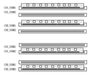
2. 插入两组相同的四个内存条(推荐使用四根完全相同的内存条):
