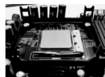
ÉTAPE 4 : Abaissez et Fermez Le Levier de Douille
