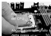
PROCEDURA 2/PROCEDURA 3: Inserire l'angolo contrassegnato del CPU nell'angolo contrassegnato nella presa
