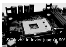
ÉTAPE 1 : Soulevez Le Levier de Douille Jusqu'à 90°
