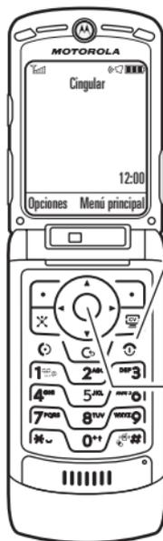
① Mantenga oprimida la **tecla de encendido**
