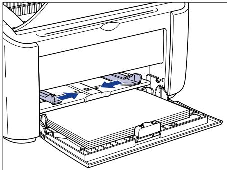
**2 装入信封时打印面应向上，信封开口闭合并向左，然后将信封轻轻地一直插入到托盘后沿。**
