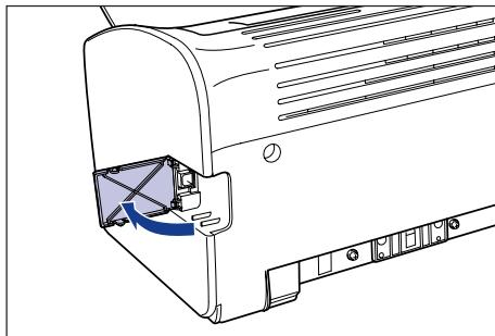
**3** 将 USB 电缆的 B 类（方形）端连接到打印机后部的 USB 连接器，然后合上 USB 盖。
