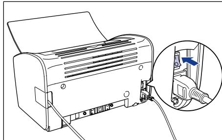
打印机的 Power 指示器亮起，打印机将运行自我诊断测试。如果自我诊断测试过程中未出错，打印机就可以打印了。
