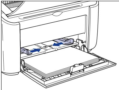
**2** 轻轻放入纸张，打印面向上，直至纸张触及托盘后沿。
