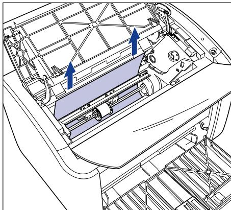
如果卡纸难以清除，可以从多功能托盘或手动送纸托盘中拉出卡纸。
