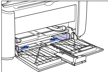
**3** 装入信封时打印面应向上，信封开口闭合并向左，然后将信封轻轻地一直插入到托盘后沿。
