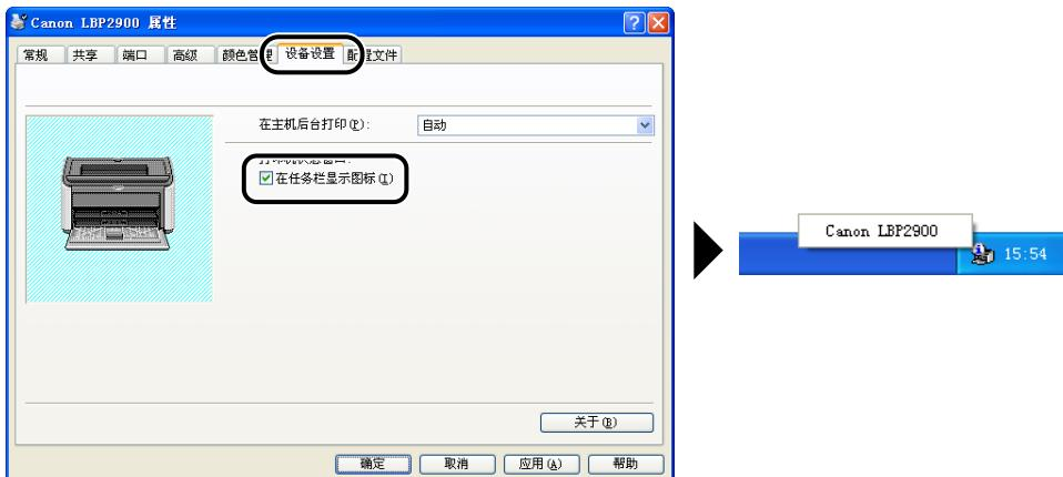
在打印过程中或在发生错误时，也会自动显示打印机状态窗口。如果未在打印机状态窗口 [选项] 菜单的 [首选项] 中将 [显示打印机状态窗口] 设置为 [开始打印时]，则打印过程中将不会显示打印机状态窗口。（请参阅第 4-55 页的“设置首选项”。）
