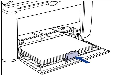
如果是从手动送纸托盘进纸时发生的卡纸故障，则将纸张装入手动送纸托盘中。
