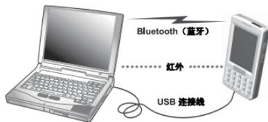
要同步，请使用 USB 连接线、Bluetooth（蓝牙）或红外连接来将手机连接到计算机。
