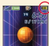
在开机状态下充满电时,电池格数不再循环闪烁,手机上方的电池图标变为黄色。
