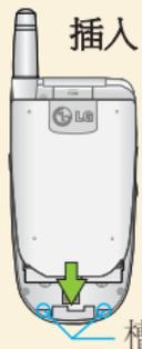
将电池“底部”和手机“底部槽”对正后按下去，直到听见“咔嚓”的响声。
