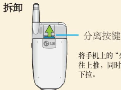
将手机上的“分离按键”往上推，同时将电池往下拉。
