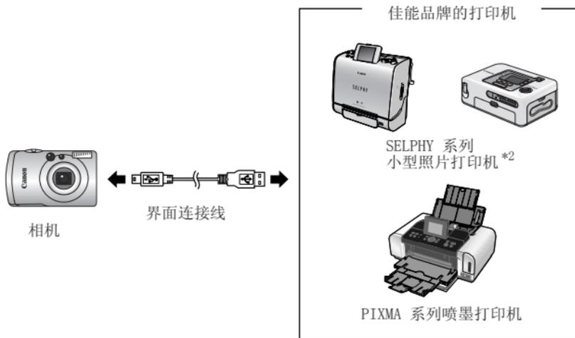
\*<sup>1</sup> 由于本相机采用标准传输协议 (PictBridge)，除了使用佳能品牌的打印机之外，您还可以使用其他兼容 PictBridge 的打印机。
