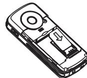
4 先放入電池下端①，再將電池上端②放入。
