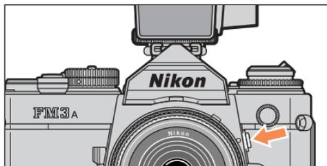
在这种情况下，按住 TTL 闪光修正按钮进行拍摄能自动降低闪光度等级，从而获得更自然和最佳的曝光效果。
