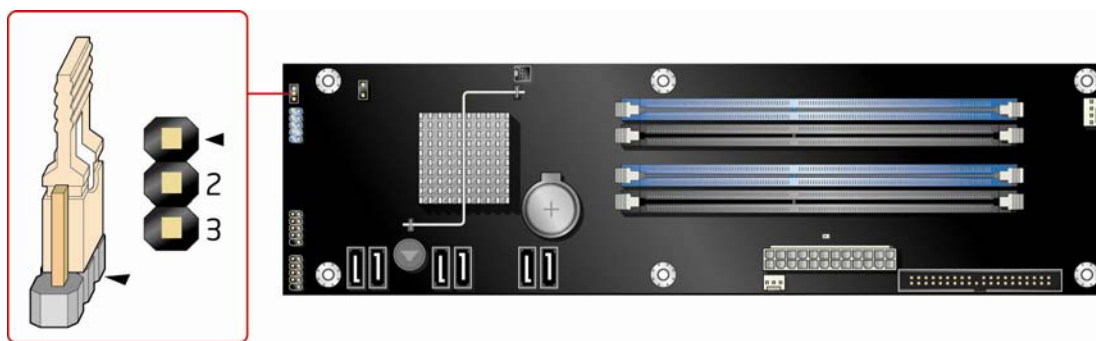
图 31. BIOS 配置跳线块位置
