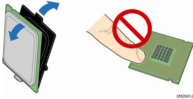
图 11. 从处理器保护罩中取出处理器
