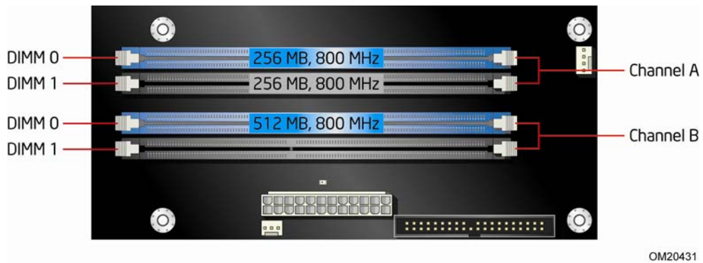
图 19. 采用三条 DIMM 的双通道内存配置
