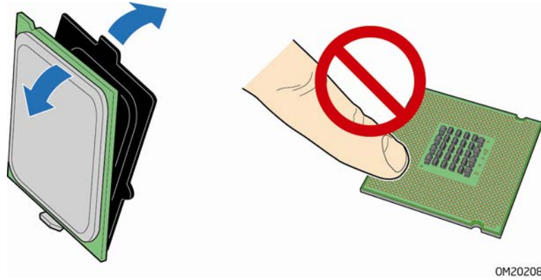
图 10. 从处理器保护罩中取出处理器
