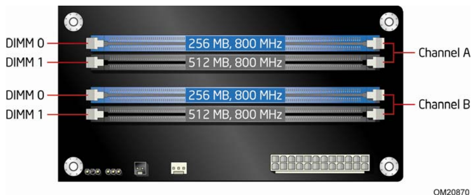
图 15. 四条 DIMM 双通道内存配置
