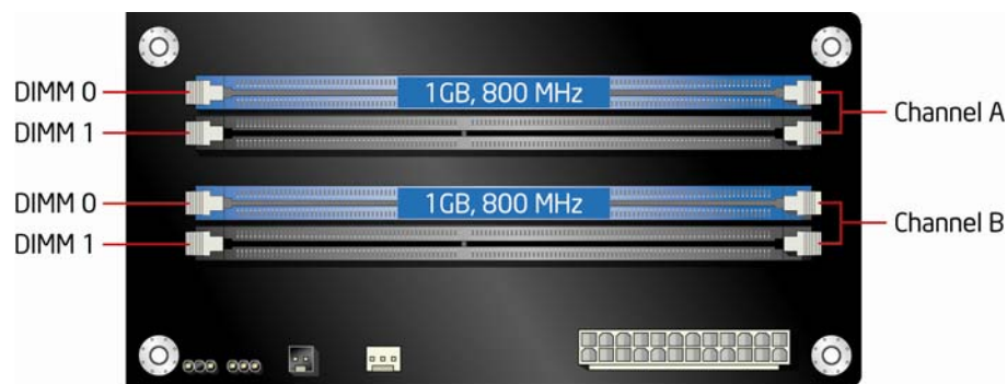
图 14. 两条 DIMM 双通道内存配置
