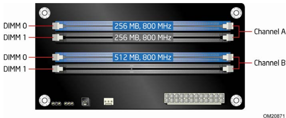
图 16. 三条 DIMM 双通道内存配置
