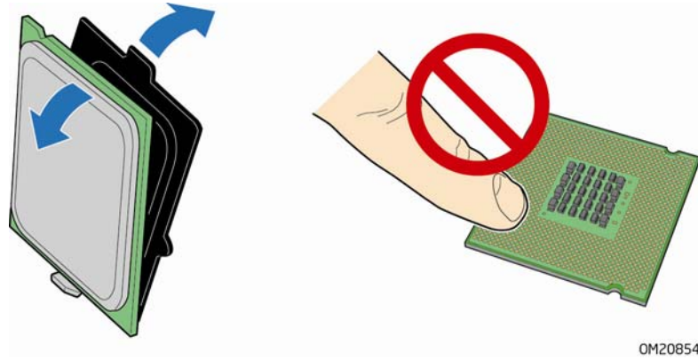
图 9. 从处理器保护罩中取出处理器
