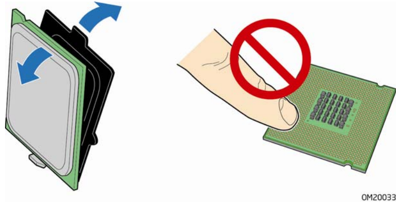
图 9. 从处理器保护罩中取出处理器
