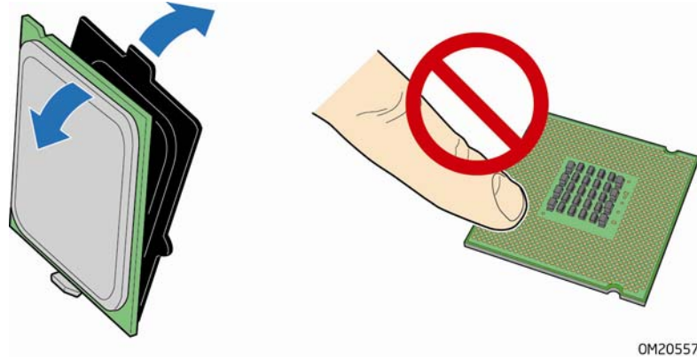
图 9. 从处理器保护罩中取出处理器
