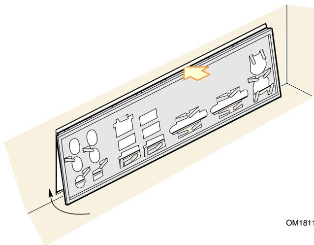
图 4. 安装 I/O 防护板
