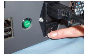
注：扫描仪将会执行自我测试程序。前面板上的 LED 指示灯将会呈绿色闪烁，LCD 指示灯显示器将会切换。完成自我测试程序后，LED 指示灯将会呈绿色稳固亮起。
