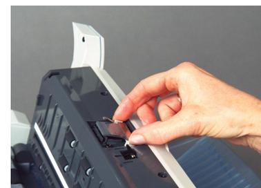
3. 将新的进纸模块对齐插槽。然后推入直到两个夹子嵌入定位，插入新的进纸模块。
