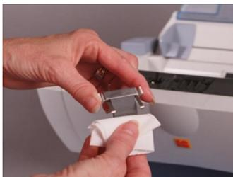
4. 检查进纸模块。如果在清洁后继续出现磨损或重张进纸，请更换进纸模块。
