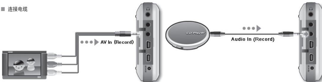
将影音电缆连接到 A2 上的“AV IN”和外接式影音设备上的“AV OUT (Video OUT, Audio OUT)”。
