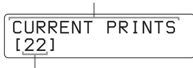
自打开打印机后的打印总数
