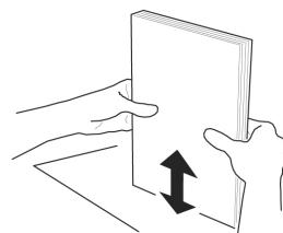
2. 插入文件（最多 20 张），将文件所要打印的面向上松散地插入进纸槽内。
