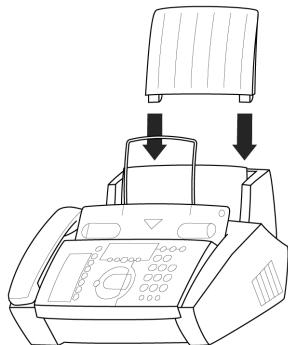
2. 为防止多张纸同时进入传真机，首先将纸散开使每张纸分离，然后将这叠纸在平面上弄直，在将其插入进纸器中。
