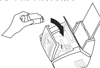
6. 通过向前拉文档支架关闭机器，然后合上操作面板。
