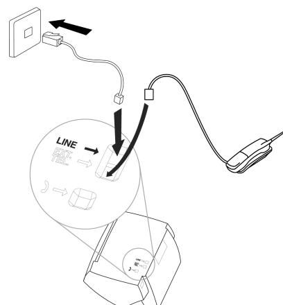
将附加设备连接到相同的插孔中以确保您传真转换的功能优化性（如：呼叫转移）。您的传真机可以控制附加设备。
