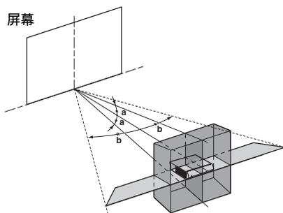
a: “垂直梯形失真校正”调节区域内的投影机的倾斜角度
