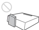
在投影期间请勿在镜头面前放置可能会遮挡光线的物品。来自光线的热量可能会造成物品损坏。请使用 PIC MUTING 键停止投影。
