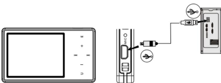
本机采用锂离子电池供电。任何时候，用USB传输线连接本机到电脑，均会自动开机开始充电，用电脑充满电大约需要2.5个小时左右。充满之后自动停止充电。
