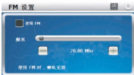
注：FM调频发射是将本导航仪的音频信号通过该调频发射到收音设备，以FM某一频率（例如76.00MHZ）为例，此时必须调节导航仪发射频率和收音机接受频率一致，都为76.00MHZ，此时两设备处于同一频段，这样导航仪上的所有发声就会通过收音设备的功放系统输出。
