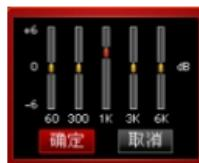
按**◀/▶**键选择调节的频段，按**+**/**-**键调节幅度值。调节幅度时以2dB为步径，最大可调范围为±6dB，设置完后短按**◀/▶**键选择“确定”，短按**M**键确认。
