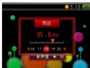
在主菜单中选择“收音机”短按 **M** 键进入收音模式，此时插上耳机即可收听广播电台，进入收音模式之后，短按 **M** 键可进入“在线菜单”。短按 **□** 键退出收音界面到主菜单，但收音仍在进行。
