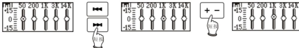
调节幅度时以3dB为步径，最大可调范围为±15dB，设置完后按▶▷键确认退出，按[M]键不保存并退出。
